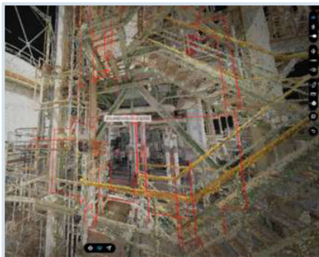
図: 3D点群データから評価対象機器を登録
