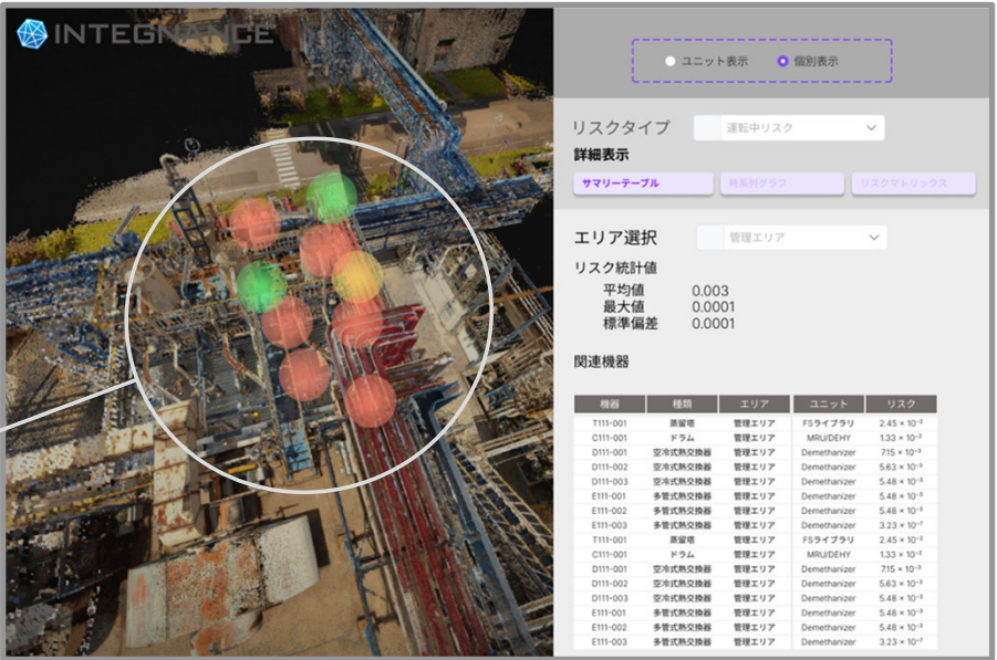
放出源抽出および危険距離算出結果の可視化イメージ
