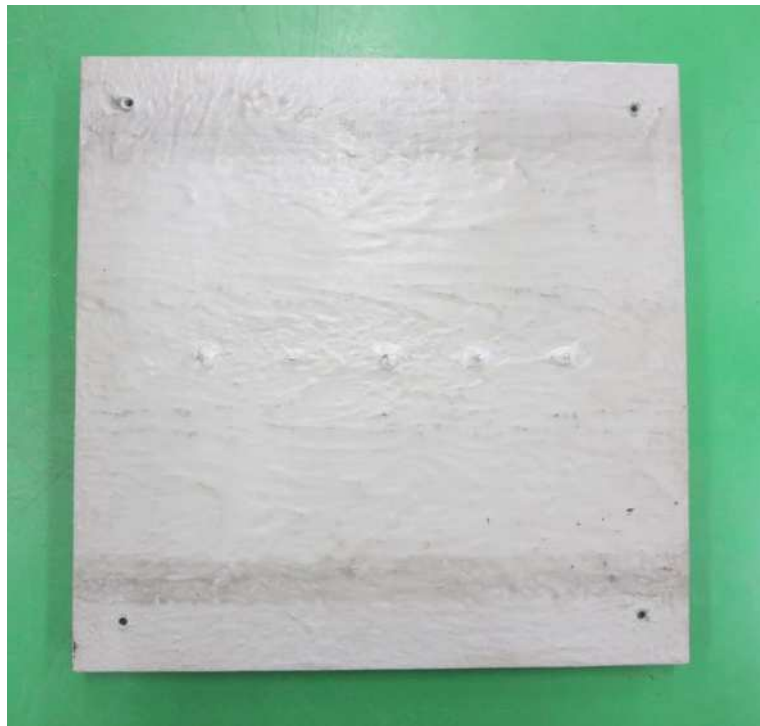
図7.4 塗装試験片(板厚12mm)
