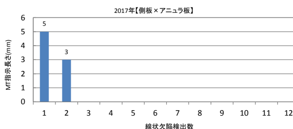
付図 2.6 溶接欠陥検出履歴（側板×アニュラ板溶接継手部）
