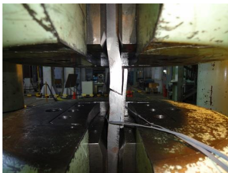
B-LF-3 破断状況(1)
