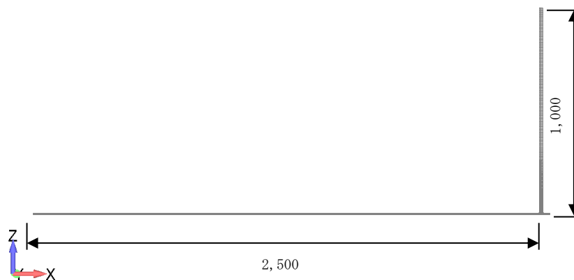
図 2.24 タンク隅角部の解析モデル
