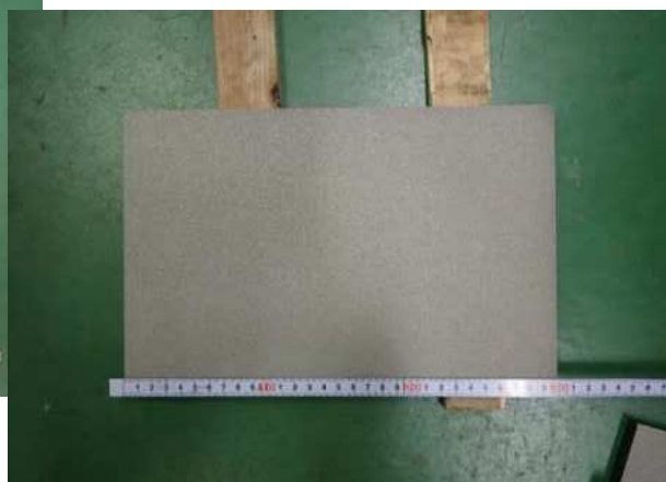
図4 表面サンドブラスト処理
