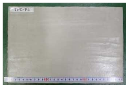
塗膜厚さ2.0mm試験体 (TPD-P4)
