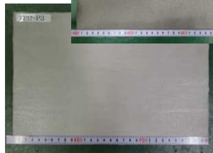
塗膜厚さ1.5mm試験体 (TPD-P3)
