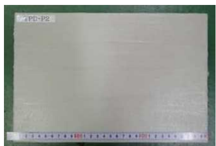
塗膜厚さ1.0mm試験体 (TPD-P2)
