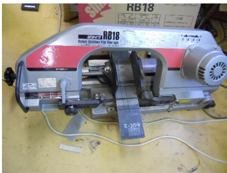
試験片の切断(1)
