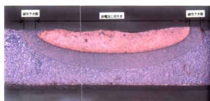
図 2.4 初期欠陥（人工欠陥）
