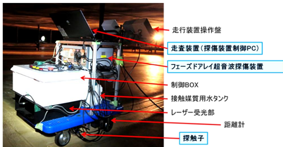
図 3.5 P A 試作機の外観
