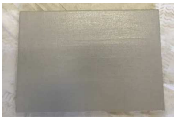
図8 上塗り後(ビニールエステルガラスフレーク)
