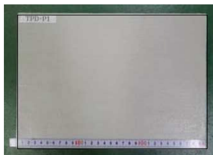
塗膜厚さ0.7mm試験体 (TPD-P1)
