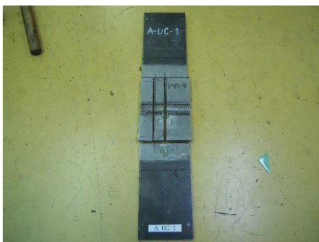
試験片切断状況
