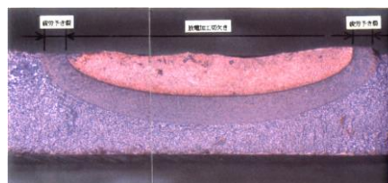
図 6.7 初期欠陥（人工欠陥）
