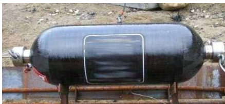
70MPa 容量 36ℓ タンク アルミ合金製ライナー+炭素繊維フルラップ仕様
