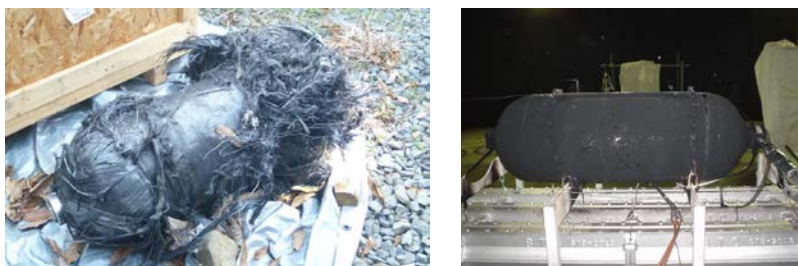
図 2 高圧水素タンク火炎暴露試験結果 (左：溶栓弁なし、右：溶栓弁あり)
