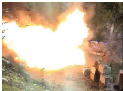
ファイヤーボール形成 約 18m 容器片 約 200m離れた平地まで飛翔
