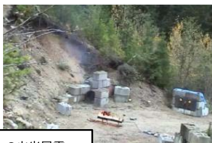
プロパンガスバーナーの火災暴露
