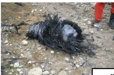
ファイヤーボール形成 約 18m 容器片 約 200m離れた平地まで飛翔
