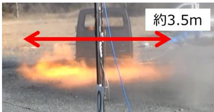
図 7 溶栓弁作動時の状況（車両後方）
