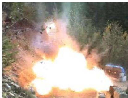
ファイヤーボール形成 約 18m 容器片 約 20m離れた山の法面まで飛翔
