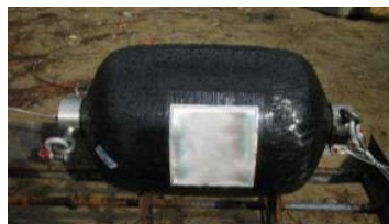
70MPa 容量 35ℓ プラスチック製ライナー+炭素繊維フルラップ仕様
