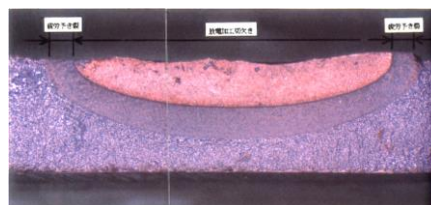
図 2.10 初期欠陥 (人工欠陥)
