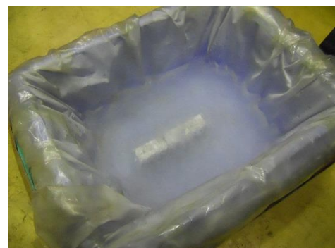
液体窒素による試験片の冷却
