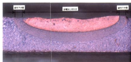
図 6.7 初期欠陥（人工欠陥）
