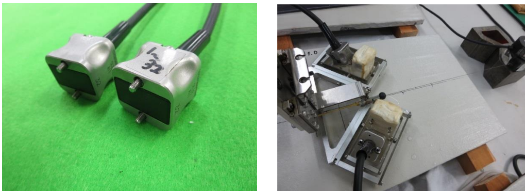
図3.6 PA試作機のフェーズドアレイ探触子の外観と探傷の様子（Bパターン）
