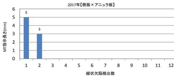
付図 2.6 溶接欠陥検出履歴（側板×アニュラ板溶接継手部）
