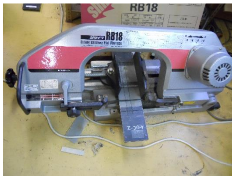
試験片の切断(1)
