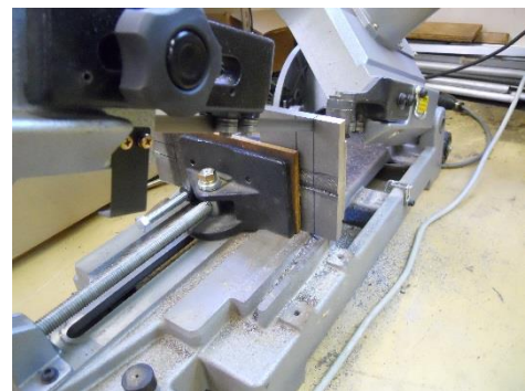
試験片の切断(2)
