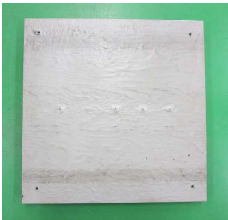
図7.4 塗装試験片(板厚12mm)
