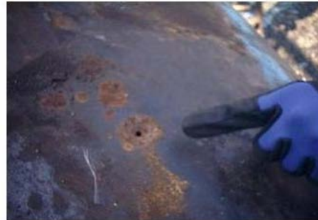
腐食によりボールペン先程度の開孔
