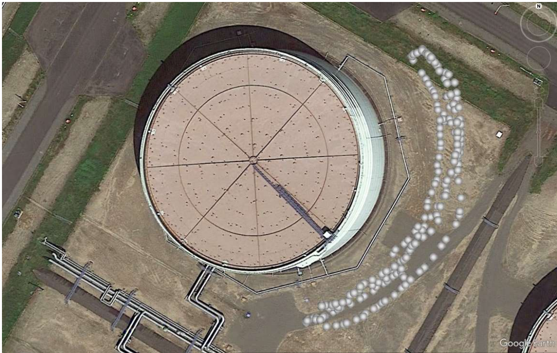
図 18 自律飛行によってタンクの側面を自動撮影した際の撮影ポイント（真上から）
