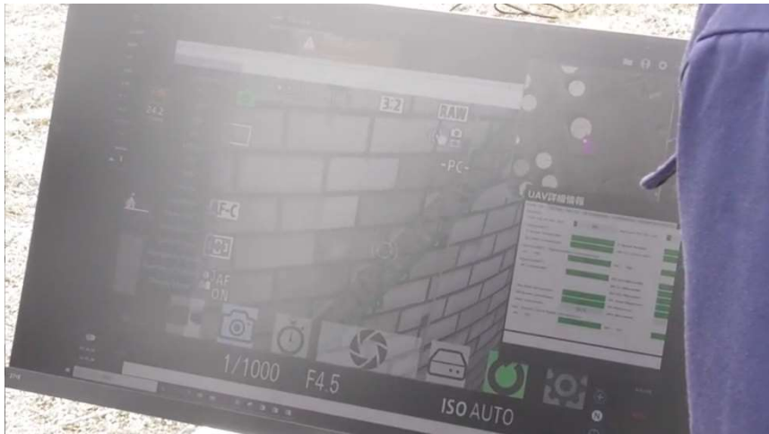
図 59 地上ディスプレイに太陽光が反射している様子
