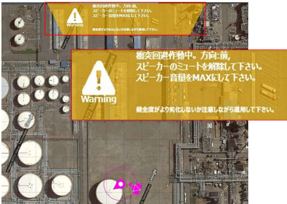
図 61 衝突回避機能作動時の飛行管理ソフトウェア上での表示
