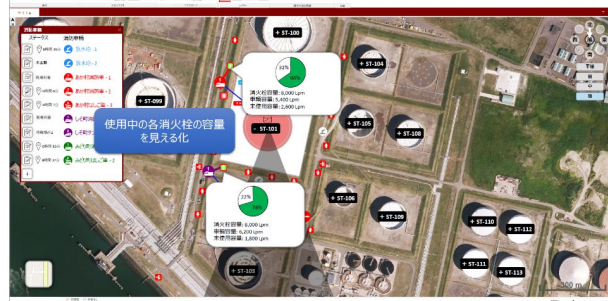
【消火栓容量の自動確認】 ⇒消火栓容量に応じた 現実的な部署位置の決定を支援
