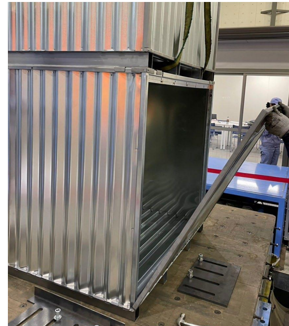
試験終了後の下段容器のパネル開閉状況
