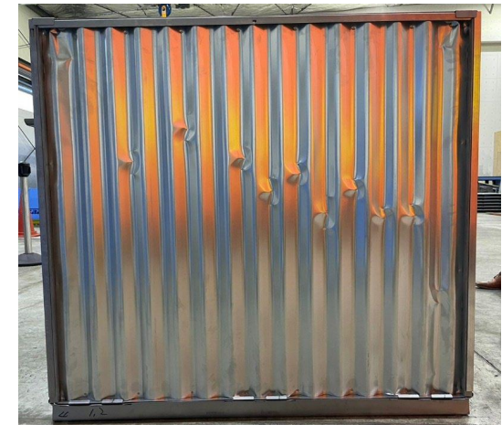
試験後（側板の座屈状況）
