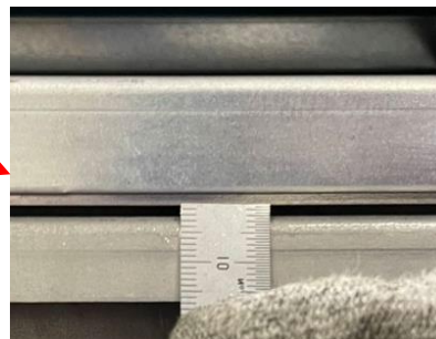
試験終了後、たわみ5mmを計測 (荷重開放で復元)
