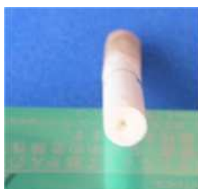
たばこ裏面の熱電対挿入位置
