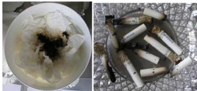
紙巻きたばこメビウスを投入したゴミ箱の中の実験後の吸殻と紙ゴミの状態
