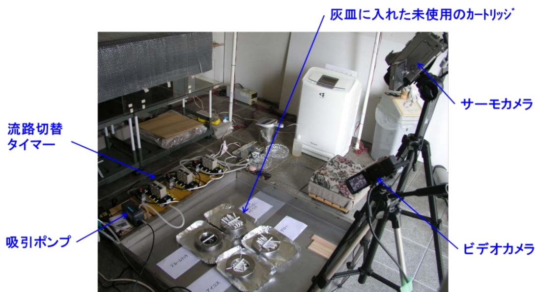
図 45 実験装置（灰皿に燃焼している紙巻たばこ投入）の外観
