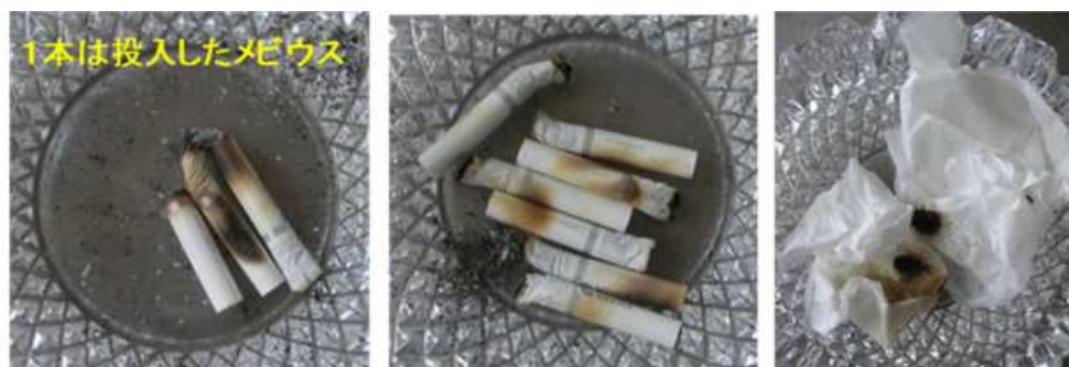
紙巻きたばこメビウスを投入したゴミ箱の中の実験後の吸殻と紙ゴミの状態
