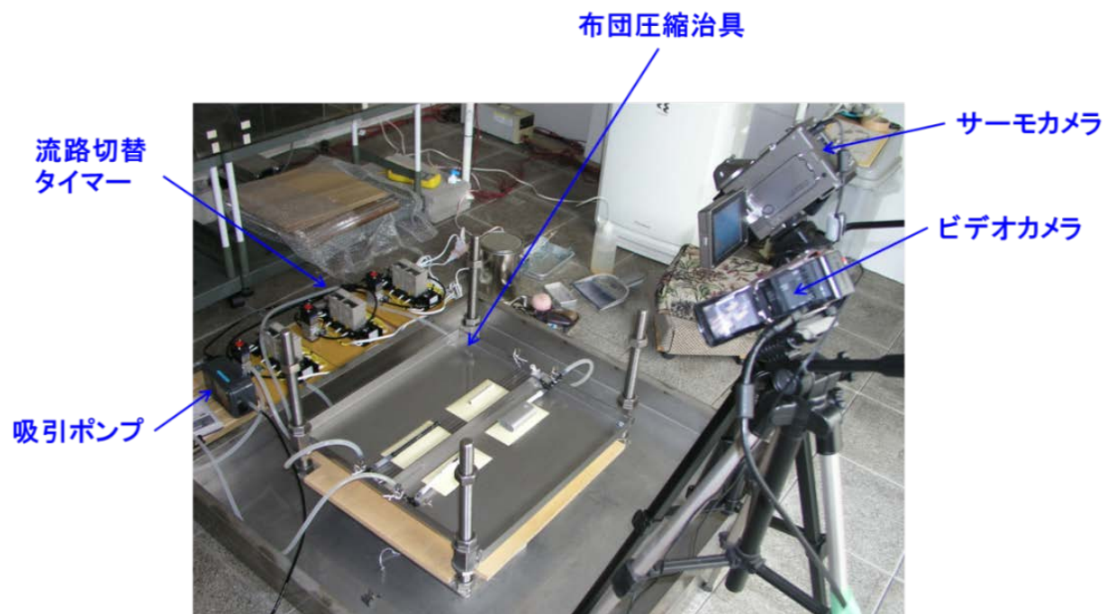
図 32 実験装置（布団類の繊維に対する着火危険）の外観
