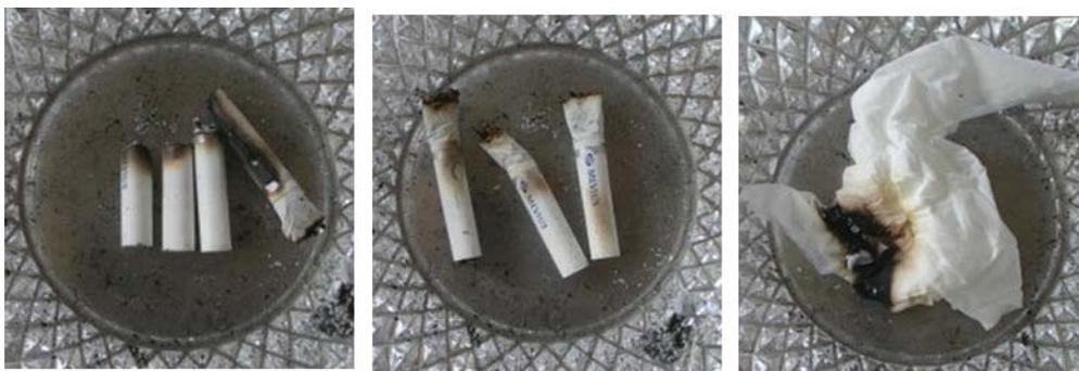
紙巻たばこメビウスを投入したゴミ箱の中の実験後の吸殻と紙ゴミの状態
