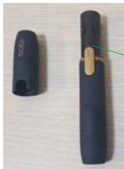
加熱部分は内部に格納されており、構造上の安全性が担保されている。
