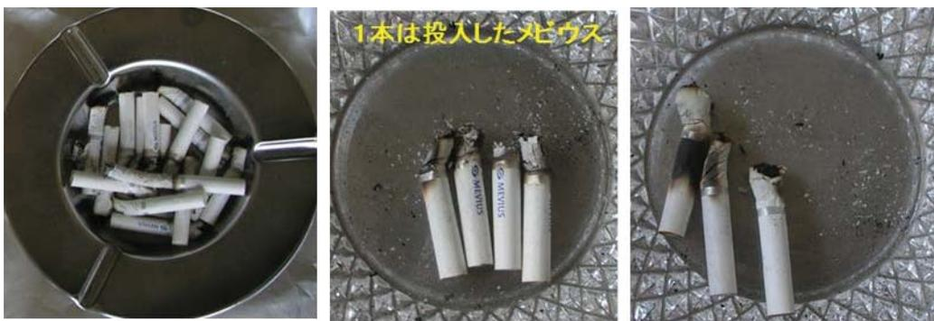
紙巻たばこメビウスを投入した灰皿の中の実験後の吸殻の状態
