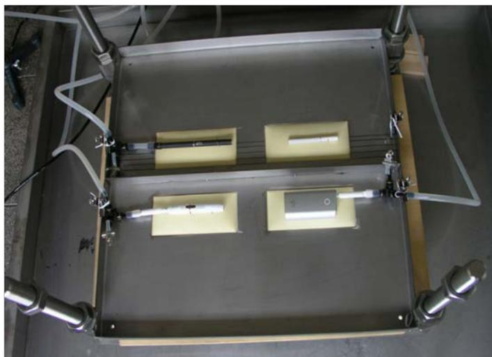
図 33 治具上面開口部のたばこ設置状況
