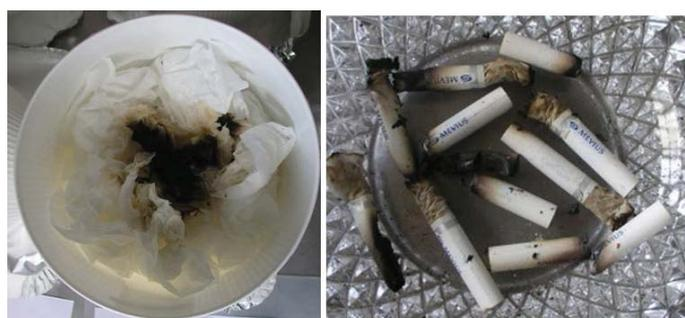
紙巻たばこメビウスを投入したゴミ箱の中の実験後の吸殻と紙ゴミの状態
