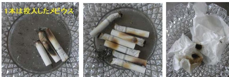
紙巻たばこメビウスを投入したゴミ箱の中の実験後の吸殻と紙ゴミの状態
