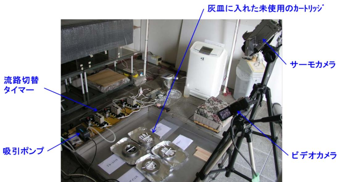
図 47 実験装置 (灰皿に燃焼している紙巻たばこ投入) の外観
