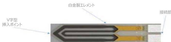
加熱ブレードの加熱は、抵抗（ヒーター全体の電圧と実際の電流）を常に監視することによって電子的に制御されています。過熱の場合には加熱ブレードオフ機能が作動します。
