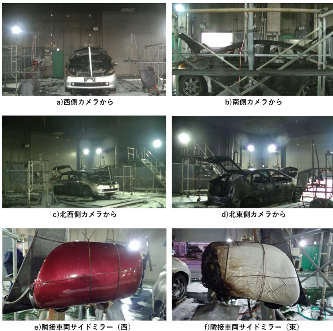
図 39 実験後の車両状況等
