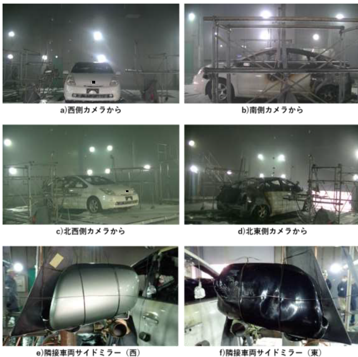
図 20 実験後の車両等状況
