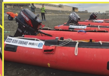
ボート復原用ロープ ボートが転覆した際に復原するためのロープ
