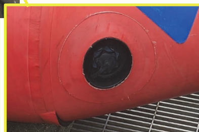
空気吸入口 空気吸入口が船体チューブ内に没している構造のため、要救助者救出時や隊員が乗船する際に吸入口に引っ掛からない構造となっている。
