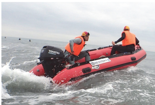
写真 4-9 波よけカバーの付け根部分に移動し、体重を船首方向にかける。
