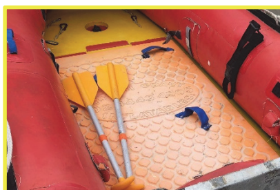
フットストラップ クルーマンズハンドル 乗船員が落水防止のために身体固定に使用する
