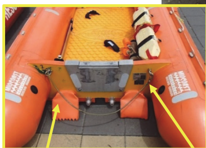
セルフバイラー（自動あか汲み） I R B内に浸水した水を効果的に排水することが可能
