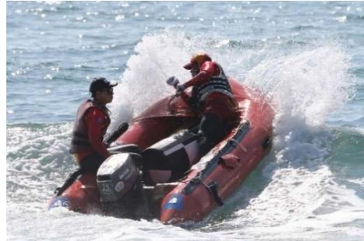
写真 4-10 波よけカバーのチューブ部分に体重をかけ、船首を押さえる。
