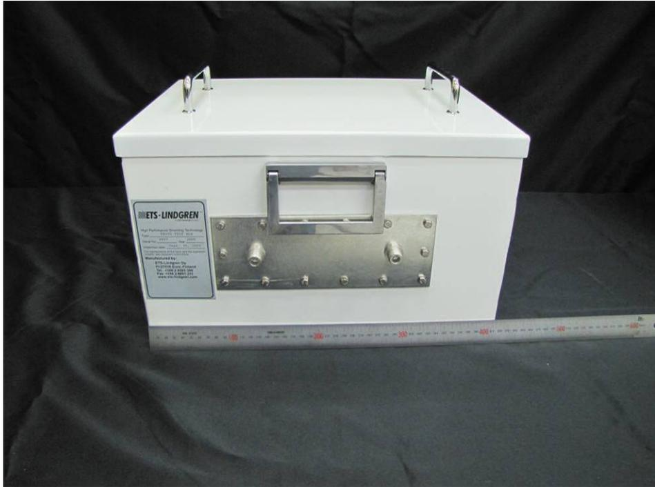
写真 2-9 海外製電波遮蔽箱（小）外観
