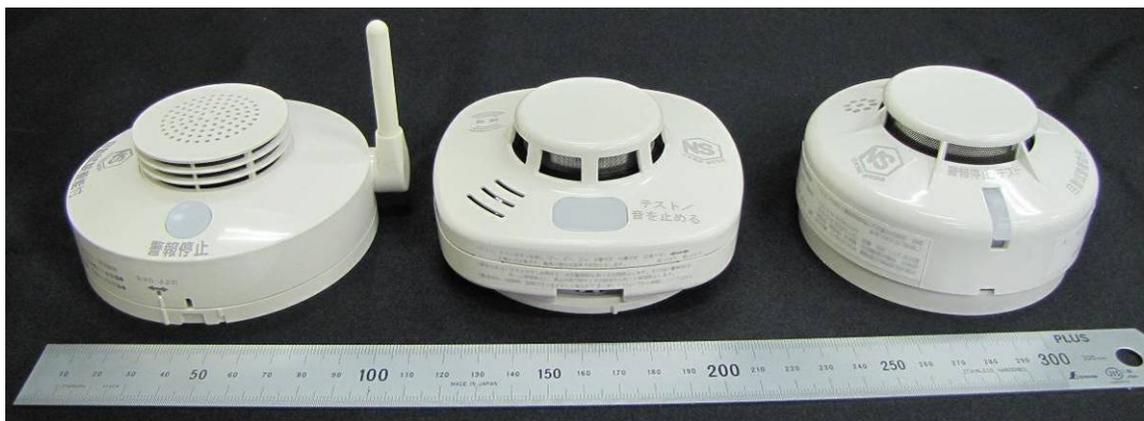
写真 2 - 6 無線式連動型住宅用防災警報器（送信部・受信部）
