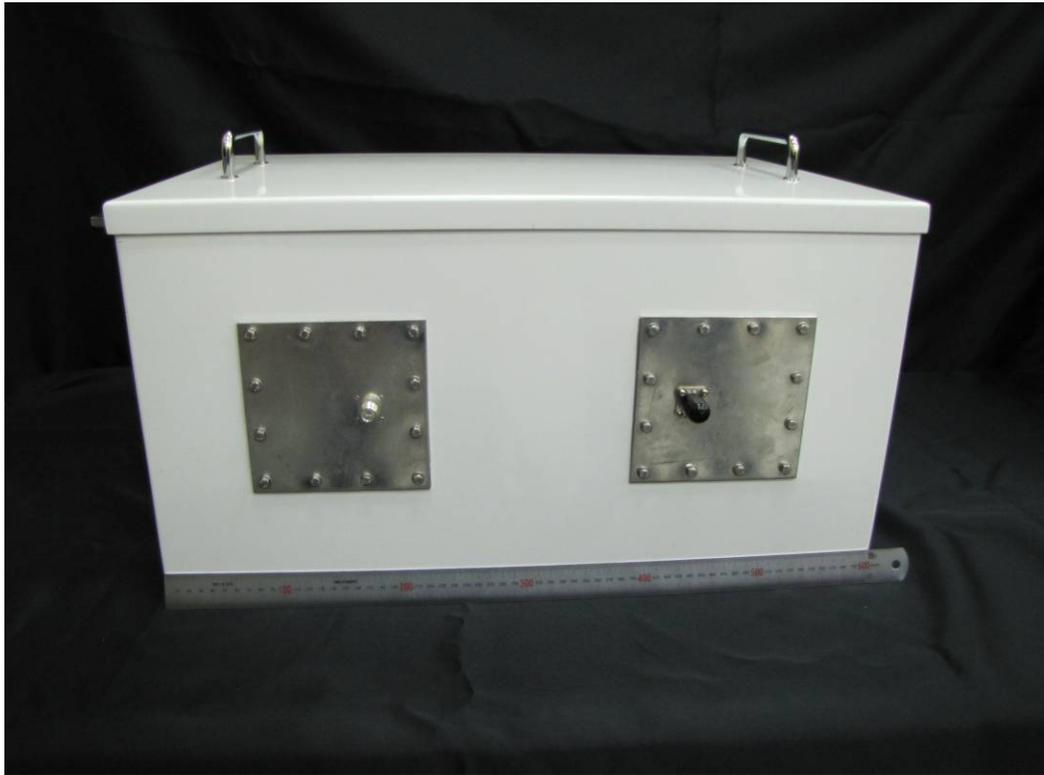
写真 2-11 海外製電波遮蔽箱（大）外観
