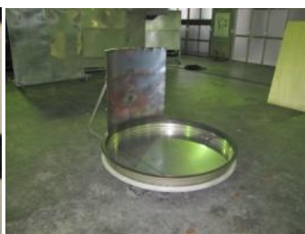
低発泡用火災模型 (背板は取り外し可能)
