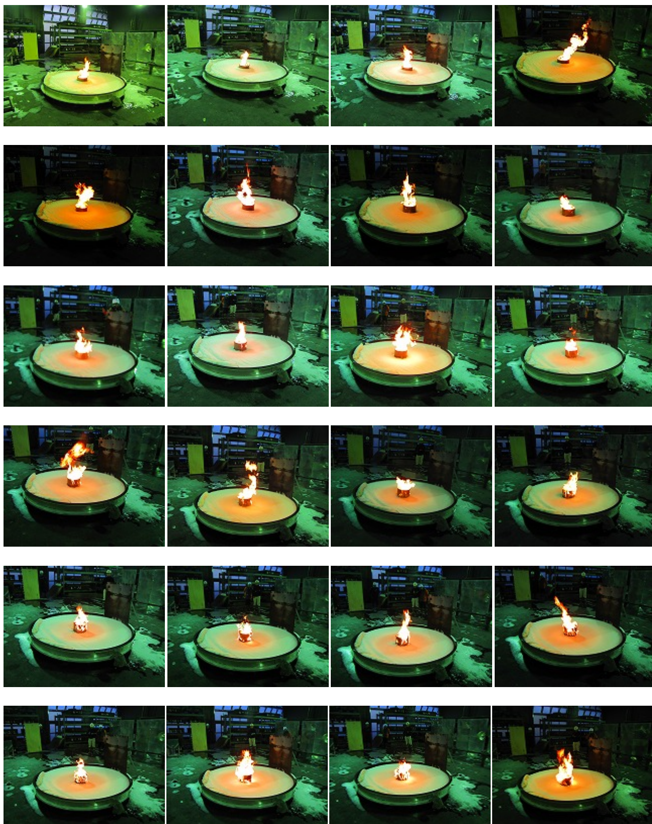
実験 No.13 gentle 水成膜泡 G (AF1) ② 実施日：平成 24 年 2 月 6 日 ※点火から 30 秒刻みで撮影
