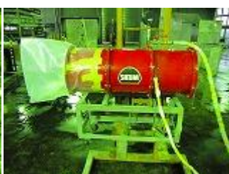
高発泡器 (放水量測定時)
