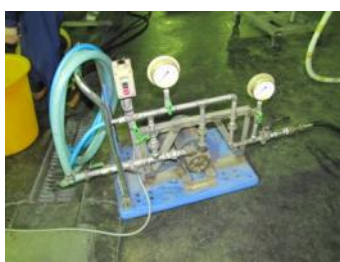
泡水溶液送液装置 (放水量測定時)
