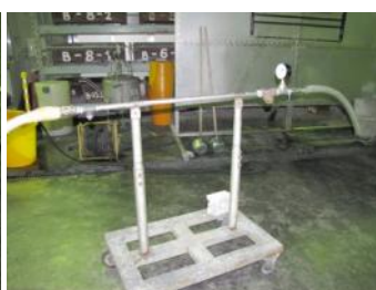
低発泡用ノズル及び設置台 (放水量測定時)
