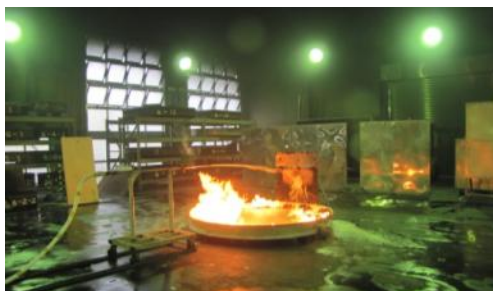
ジェントル方式の消火実験
