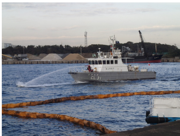
流出油の処理 (分散処理)
