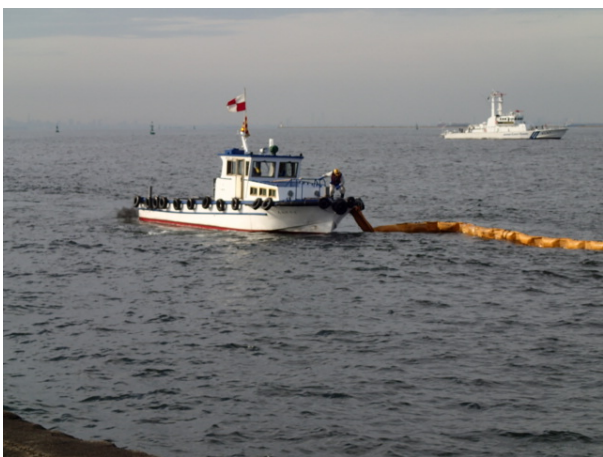
流出油の処理 (オイルフェンスの展張)
