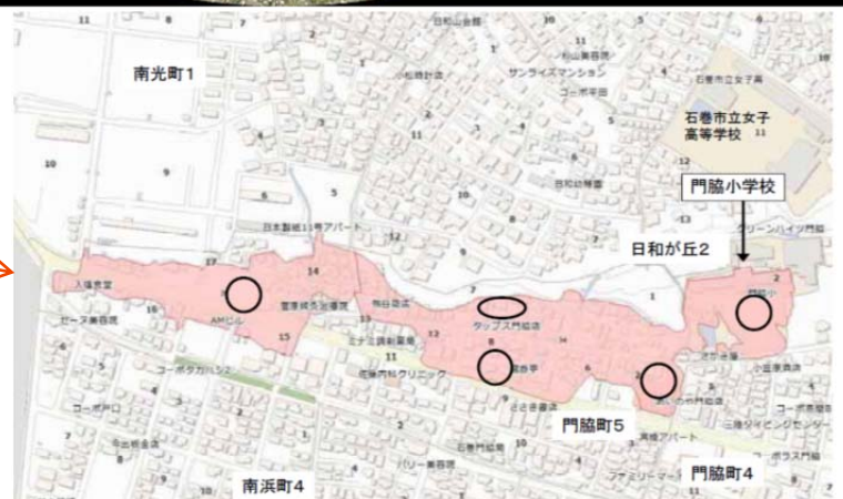
宮城県石巻市での火災（門脇小学校付近） 津波襲来直後に5箇所から出火し、延焼面積 58,000 m 2 （消防研究センターの調査から）
