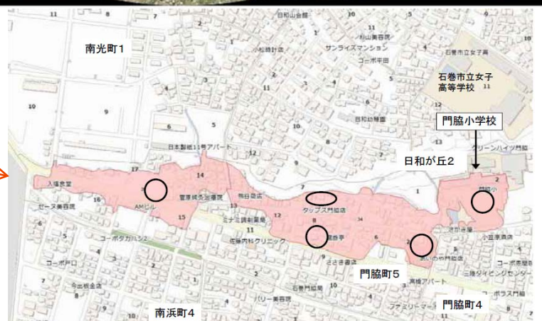
宮城県石巻市での火災（門脇小学校付近） 津波襲来直後に5箇所出火し、延焼面積 58,000 m 2 （消防研究センターの調査から）
