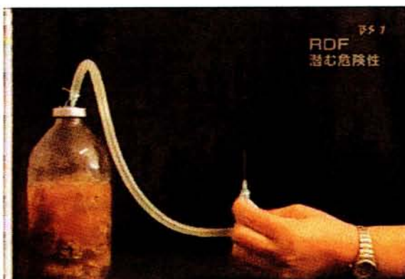
嫌気発酵による可燃性ガスの発生実験
