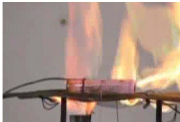
電解液が噴き出した後、バーナーの火炎に着火し、激しく燃焼する。
