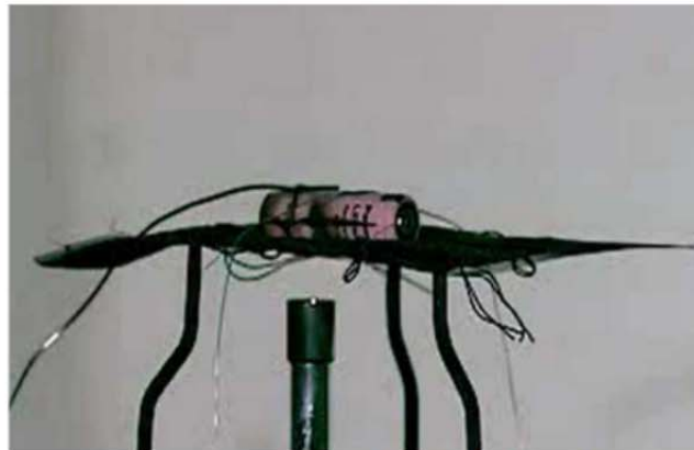
バーナーにより電池を加熱
