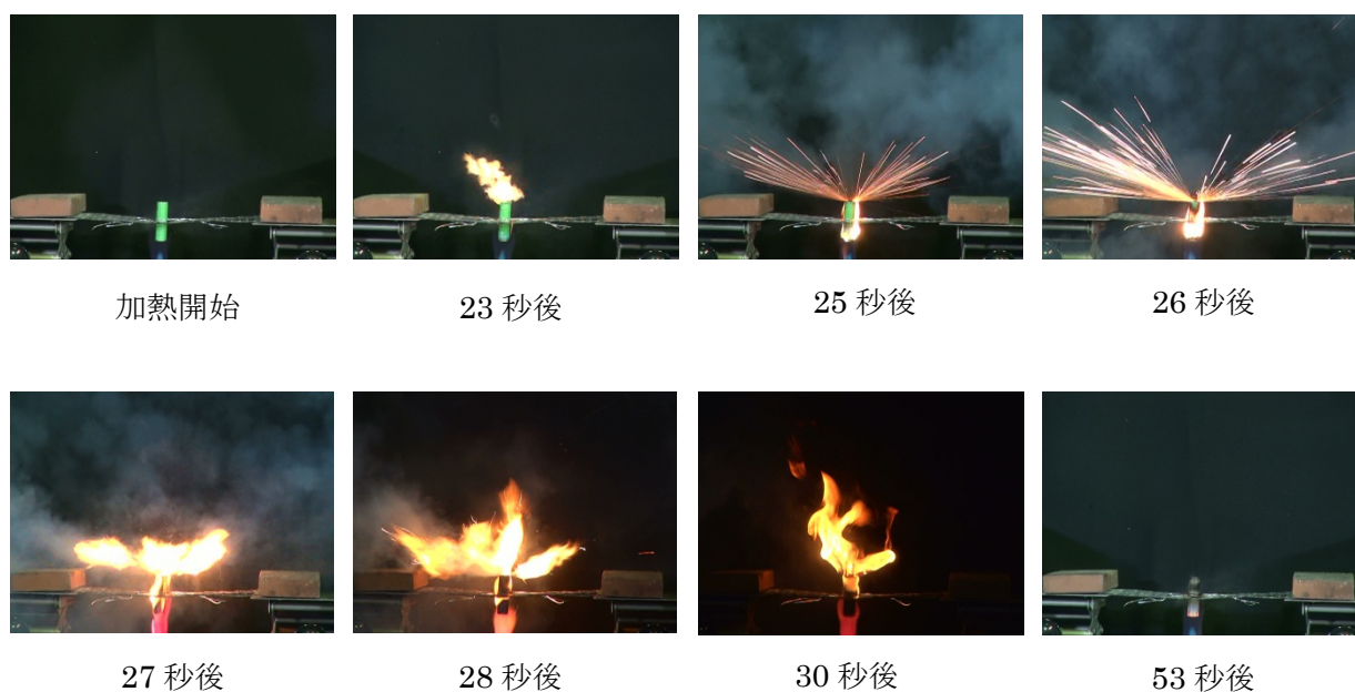
図 7 実験の経過状況（封口後の蓄電池（充電率 50%） （11/17 に実施した実験のもの（1 回目））
