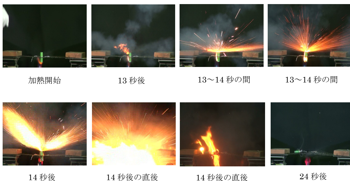
図 8 実験の経過状況（封口後の蓄電池（充電率 100%）） （11/17 に実施した実験のもの（1 回目））
