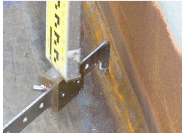
写真 4.1 側板外周部測量用治具
