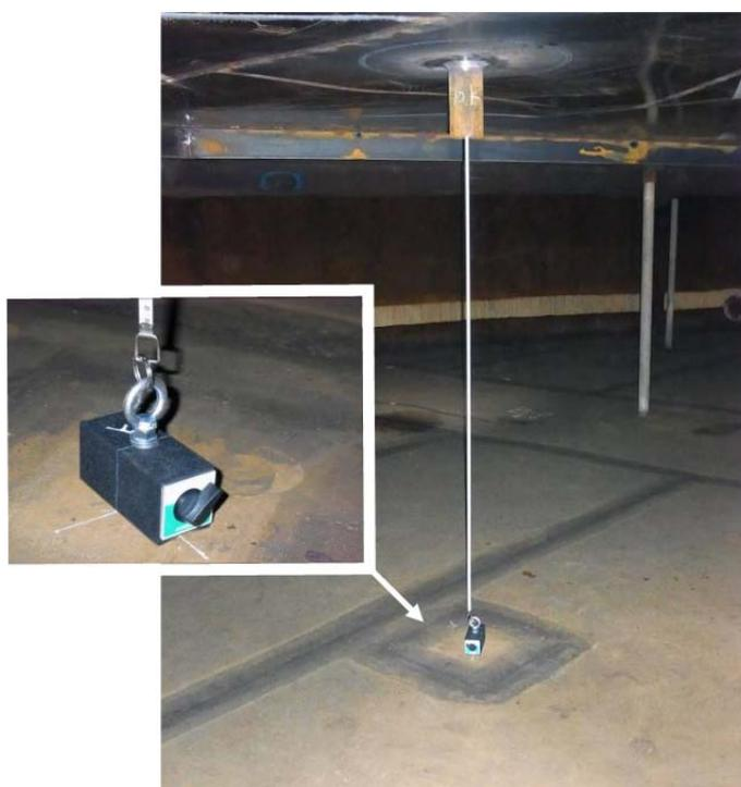
写真 4.2 タンク内底板部に設置した鋼製巻尺
