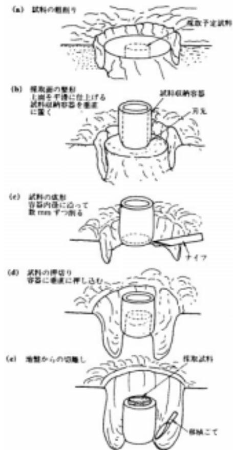
図 2-4-3 押し切り式ブロックサンプリングの手順
