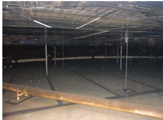
タンク内鋼巻尺設置状況
