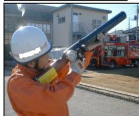
携帯用コンクリート破壊器具
