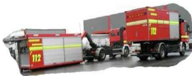
【危険物対応コンテナを下した状態】
