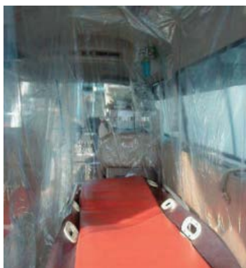
患者収容部分を分画した例（内部）
