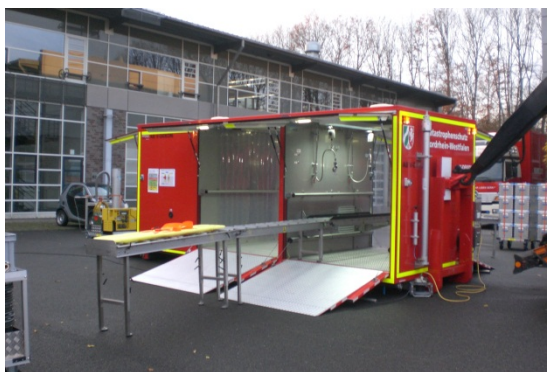
【展開された除染コンテナ】
