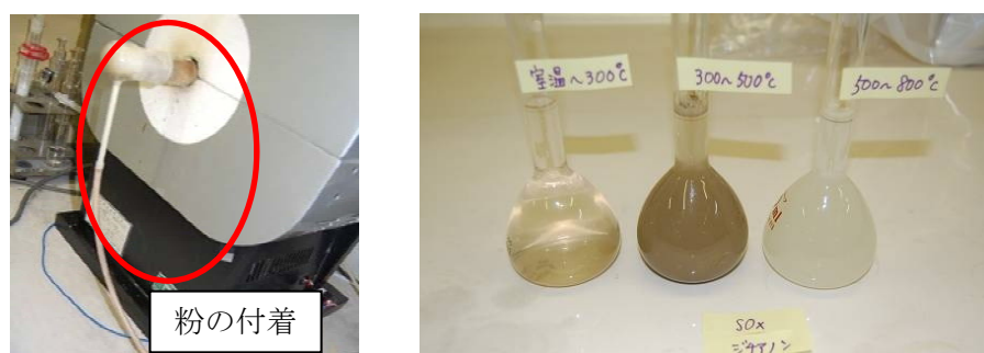
図8 ジチアノン試験時の粉塵発生状態
