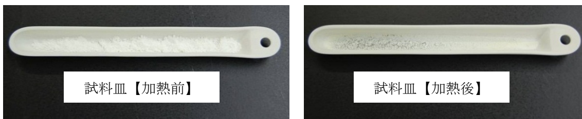
図6 酸化フェンブタスズ 加熱発生ガス試験前後の試料状態
