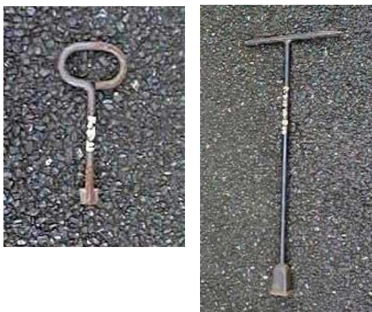
図 8-8 消火栓かぎ及び スピンドルドライバーの例
