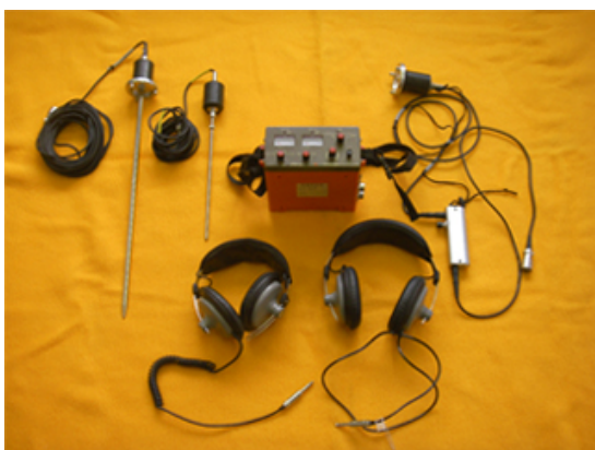
図 8-3 地中音響探知機の例
