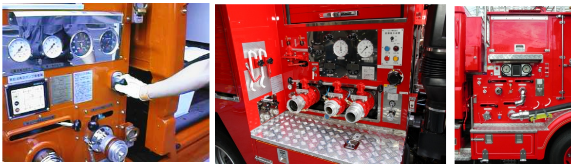
図 8-6 消防ポンプ自動車操作盤の例
