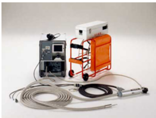
図 8-3 地中音響探知機の例
