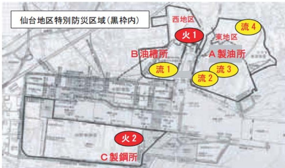
図 1.3 東北地方太平洋沖地震・仙台地区における流出・火災状況
