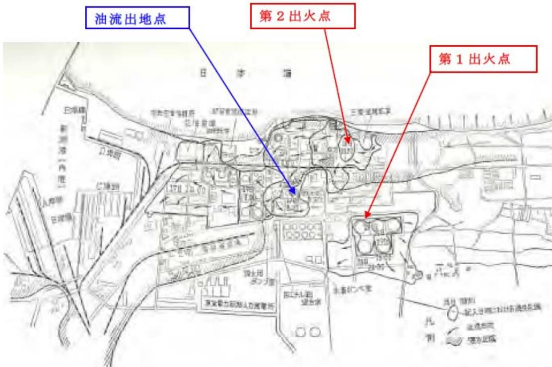
図 1.1 昭和石油新潟製油所における出火・延焼の状況<sup>4)</sup>
