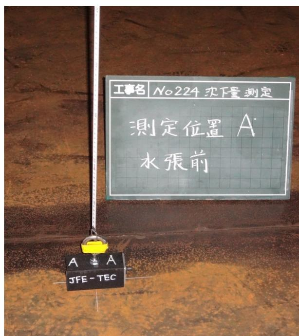
写真 3.3.2 タンク内底板部に設置した鋼製巻尺
