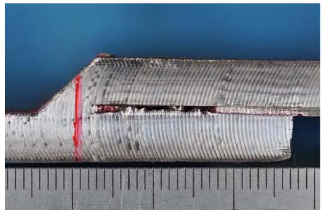
写真 2-1-14 試験片溶接部側面の写真
