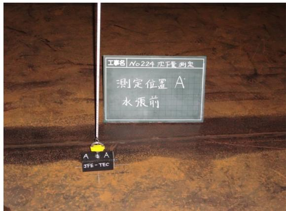
鋼巻尺設置状況 (タンク底部)
