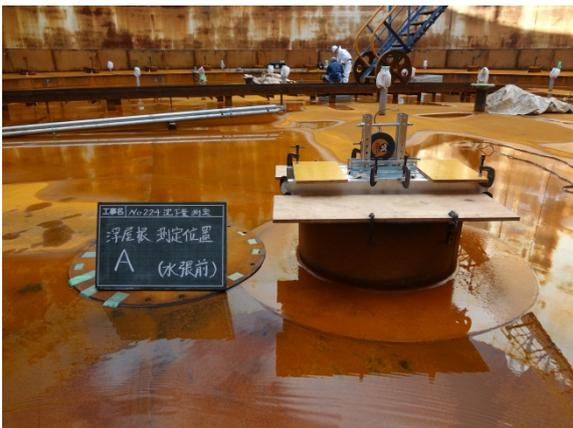
鋼巻尺設置状況 (浮き屋根上)
