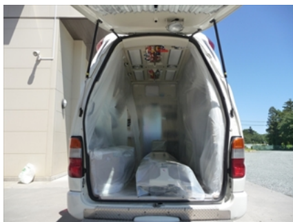
②側面の養生（両側）
