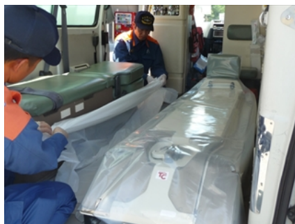
⑥最後に床面を収納 収納後、汚染検査を実施
