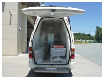
③天井及びハッチの養生
