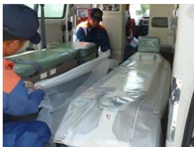
⑥床面の養生シートは、最後に内側に丸めながら除去後、汚染検査を実施
