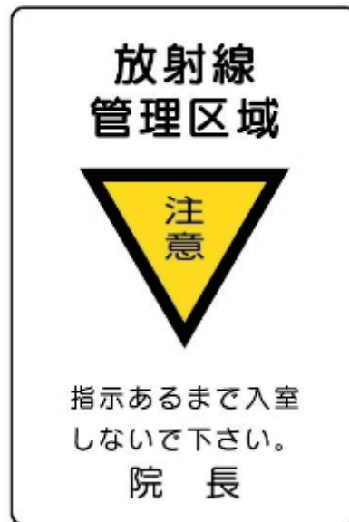
図 2-1-5：エックス線装置等を設置された部屋の入口
