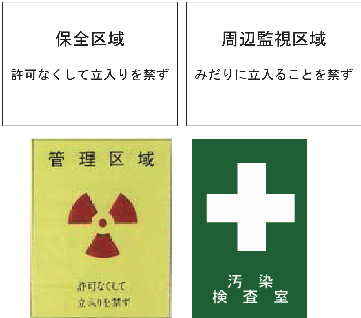
図 2-1-2：管理区域等に設置されている標識（原子力施設）
