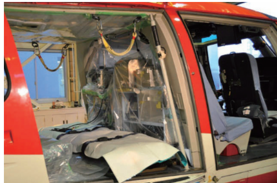
4. 操縦席へ汚染拡大させないための養生
