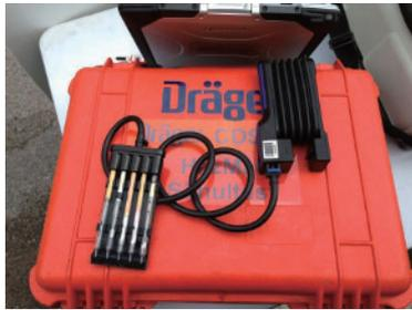
化学剤検知器 Dräger Tubes
