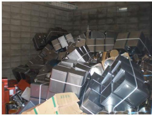
地震により落下した貯蔵庫内の容器 (出典：消防庁)
