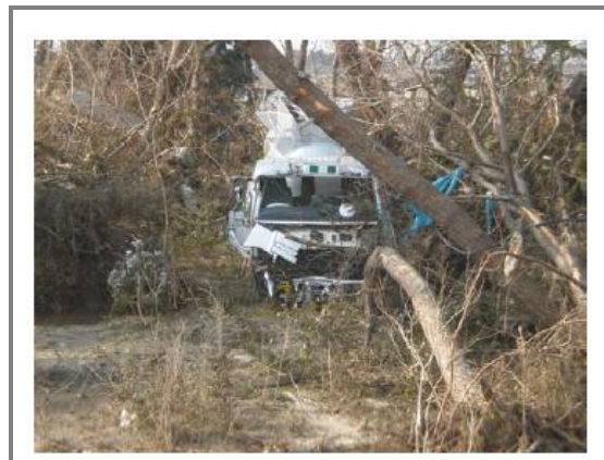
津波により破損した移動タンク貯蔵所 （出典：消防庁）
