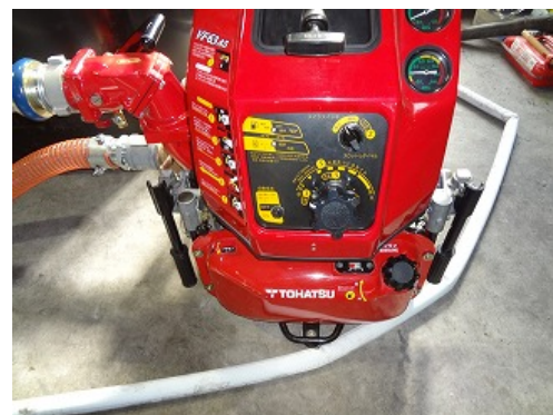
ポンプ圧力調整部
