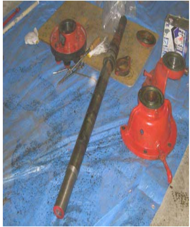
ポンプ主轴の抜取り後
