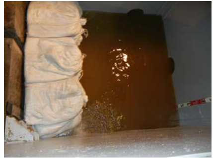
図 土のう(外側)水圧試験状況
