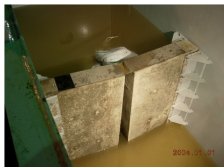
図 防水シート(湿潤、内側、土のう併用)水圧試験状況
