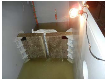
図 土のう(内側)水圧試験状況
