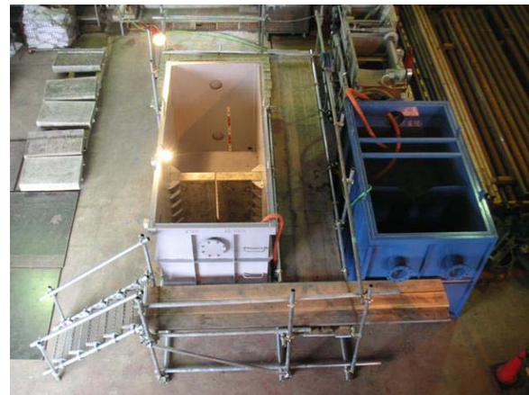
図 壁体を設置した水槽
