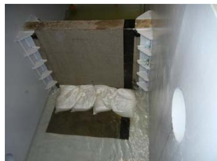
図 防水シート(乾燥、外側)水圧試験状況
