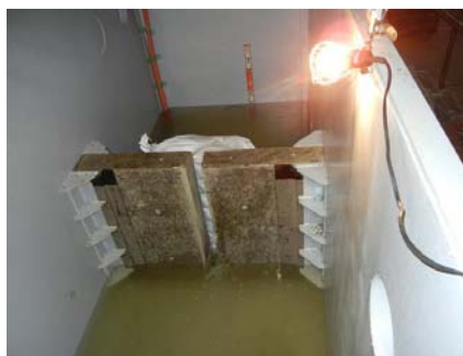
図 土のう(内側)水圧試験状況
