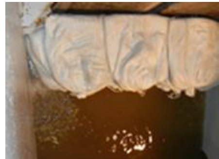
図 土のう(外側)水圧試験状況
