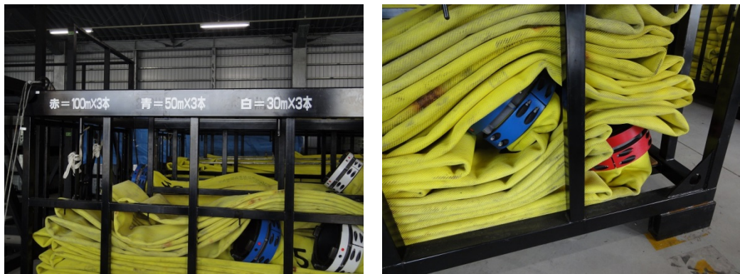
写真 2-14、2-15 コンテナに記載された凡例及び色分けされた結合金具の状況
