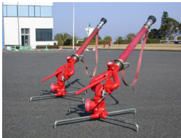
写真 1-4 可搬式放水銃
