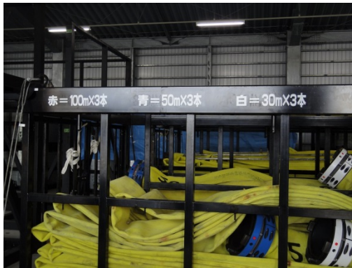
写真 2-14、2-15 コンテナに記載された凡例及び色分けされた結合金具の状況
