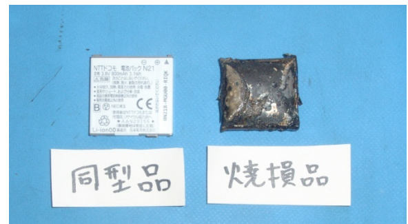
写真8 充電電池外観の状況
