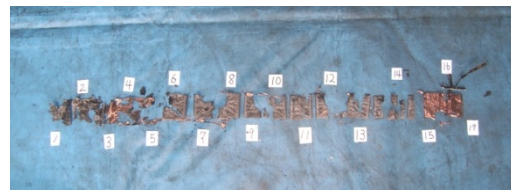
写真 25 充電電池内負極側銅箔の焼損状況
