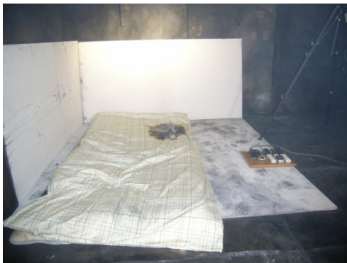
写真 22 敷布団の焼損状況
