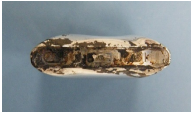
写真 11 充電電池封口板の状況
