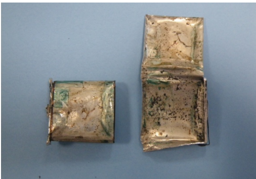
写真 12 外装缶を取り外した状況
