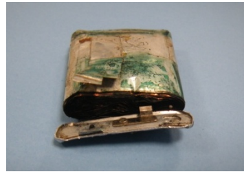
写真 13 充電電池内部の状況
