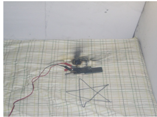
写真18 敷布団の焼損状況
