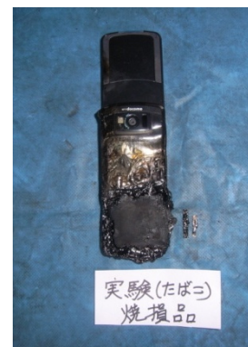
写真 26 たばこ静置実験の携帯背面焼損状況
