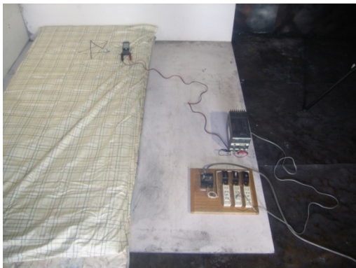
写真16 過電流による充電電池の実験設定状況
