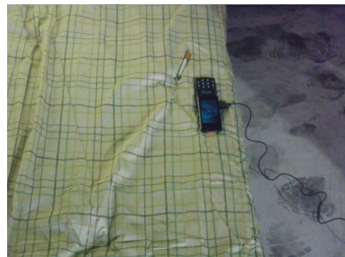
写真20 火の着いたたばこの静置による燃焼実験
