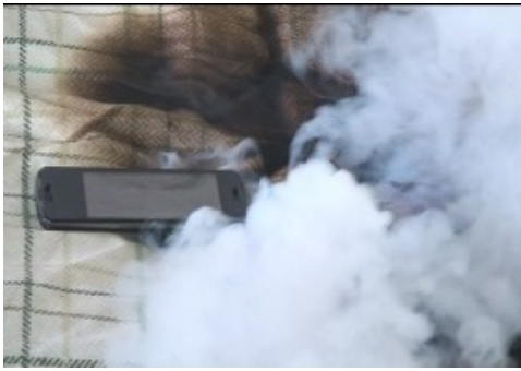
写真 21 外熱により受熱し白煙を噴出
