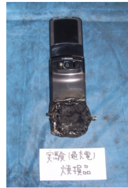
写真 24 過充電実験の携帯背面焼損状況
