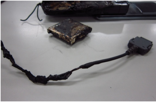
写真7 充電器コード被覆の熔融状況
