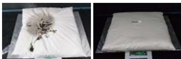
図 2 布団被覆なし実験終了時 (左:くん焼継続時、右:燃焼停止時)
