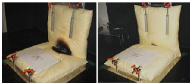
図3 実験終了時(左:くん焼継続時、右:燃焼停止時)
