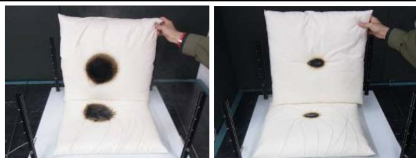
図 3 実験終了時(左:くん焼継続時、右:燃焼停止時)
