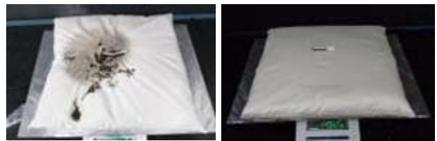
図 2 布団被覆なし実験終了時 (左:くん焼継続時、右:燃焼停止時)
