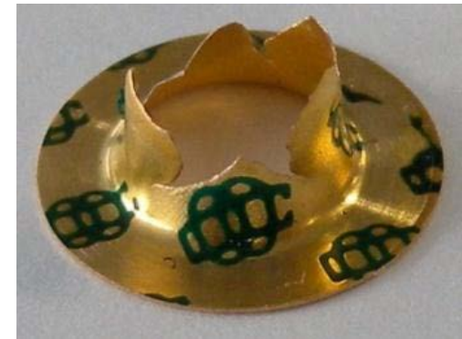
破壊後の安全封板
