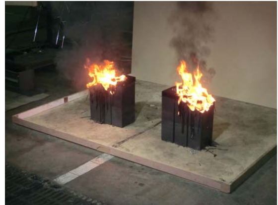
充電状態電池 放電状態電池
