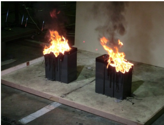
充電状態電池 放電状態電池
