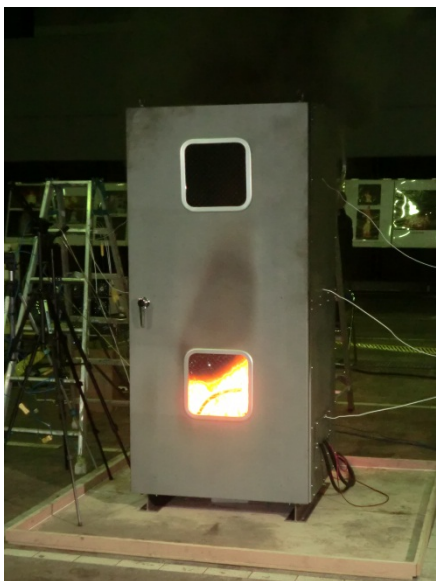
鉛蓄電池延焼状況③
