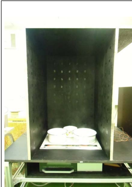
燃焼実験状況（IH単独）
